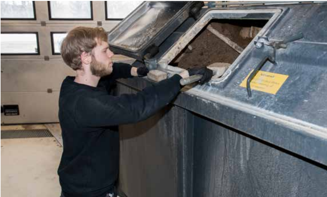
Sjekk av temperaturmålere for å dokumentere hygienisering.
